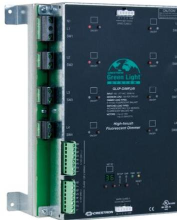
**0-10V DIM (-):** (1) 8-полюсная клеммная колодка<sup>[3]</sup>, общая клемма для диммируемых каналов, гальванически развязаны;
